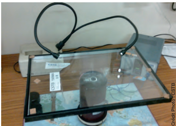
Système de mesure de point de rosée
