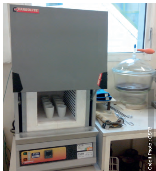
Creusets de déshydratant dans four à 540\text{ }^{\circ}\text{C}
